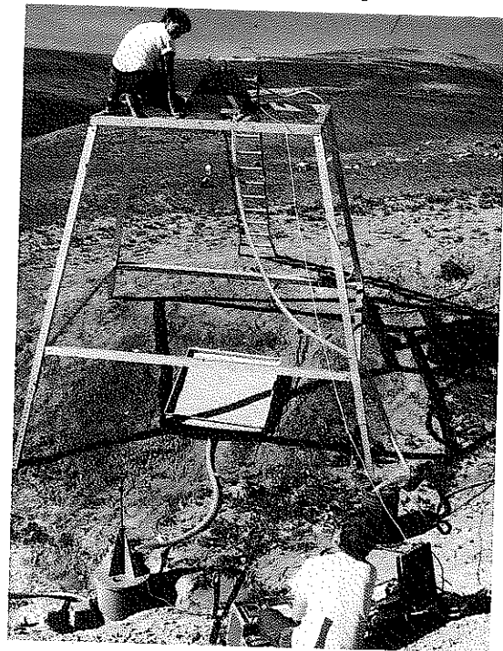
Groß- (↑) und Kleinregnerversuche (↓) im Untersuchungsgebiet 'Telfit' zur Bestimmung des Infiltrations- und Erosionsverhaltens von Mergelböden
