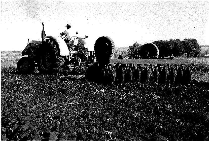
Abb. 4.3: Die schwere Scheibenegge, das am häufigsten verwendete Bodenbearbeitungsgerät, führt zu erheblichen Erosionsschäden in Paraná. (Photo: C. Roth)
