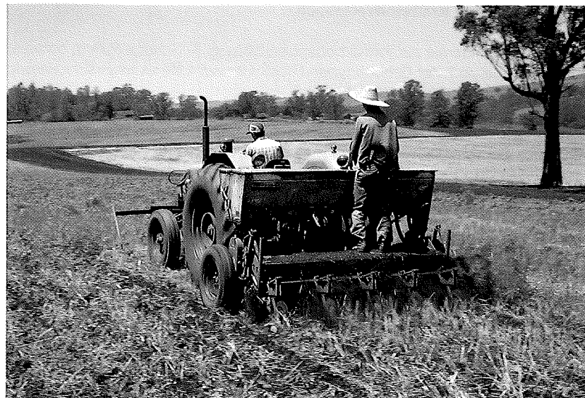
Abb. 4.7: Direktsaat von Sojabohnen mit dem Fräsrillengerät (50 cm Reihenabstand). (Photo: R. Derpsch)
