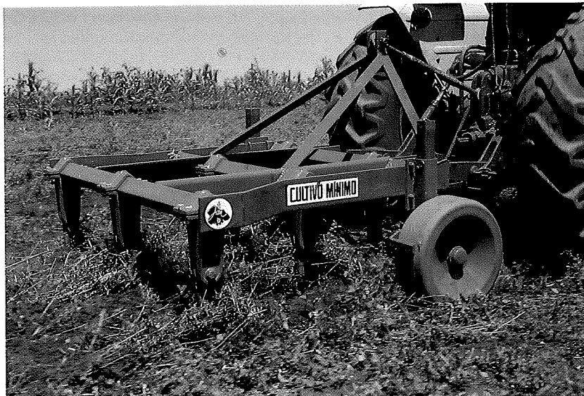
Abb. 4.5: Neu entwickelter Grubber in Brasilien. Durch Abnahme eines Zinkens kann das Gerät als Streifengrubber verwendet werden und benötigt dann nur 60 PS Zugkraft. (Photo: R. Derpsch)
